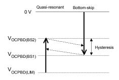
Figure 18. Operation mode shift
